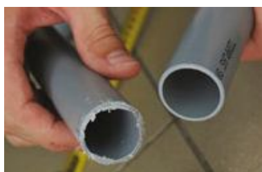
Corte com serra de metais (esquerda) contra corte com o P-TEC 3240 (direita).
