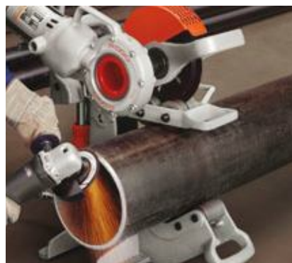
Modelo 258 com rolo de tubo para biselagem. Recomendam-se dois operadores para esta operação
