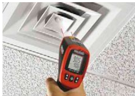
Medir a eficiência da dissipação de calor para revelar e localizar perdas térmicas em sistemas de fluxo
