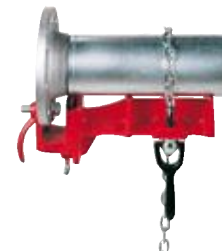
Torno para soldar tubos em flange
