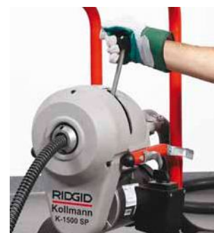
Liberte o punho e o cabo pára automaticamente
