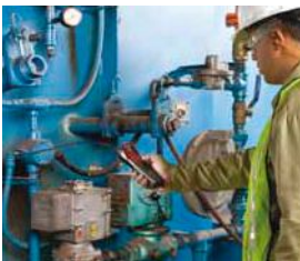
Use o micro CD-100 para detectar gases em aplicações de manutenção de fábrica e edifícios
